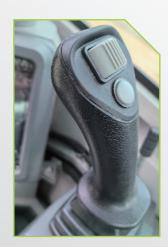
ELECTRIC PROPORTIONING JOYSTICK FOR A HIGH-CONFIGURATION MACHINE
